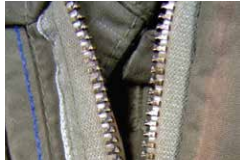
의복 염색에 사용되는 화학 물질로 인해 금속 엘레먼트의 변색 및 직물에 얼룩 이염이 발생할 수 있습니다.
