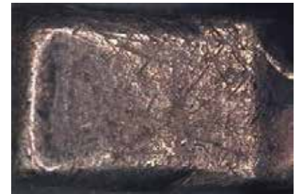
엘레먼트와 같은 금속 부품의 표면이 긁혀있다. 긁혀 나온 금속 분진이 의류에서 씻겨 나온 먼지와 섞여서 얼룩의 원인이 된다.
